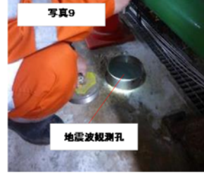
【別図 5.23】 深度 300m における撤去対象の観測機器 (2/2 : ボーリング孔関連機器以外の機器)
